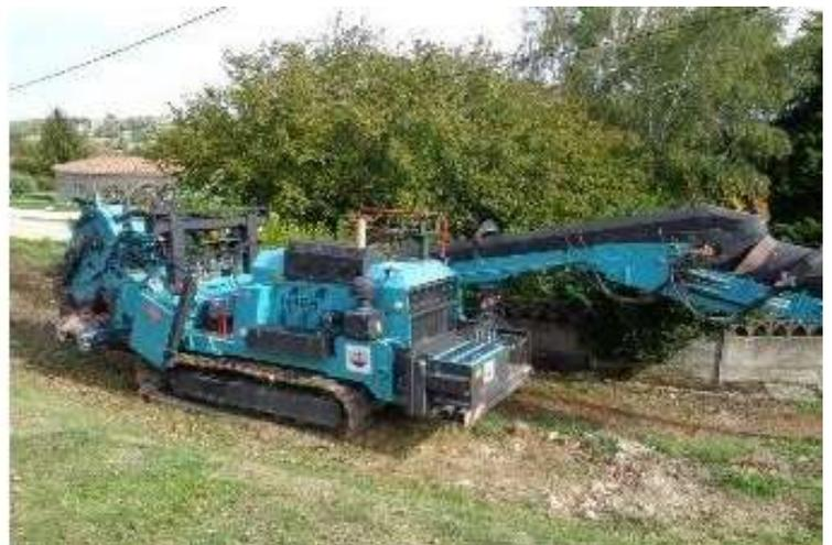
Travaux cana à la trancheuse et par fonçage sur Clermont
